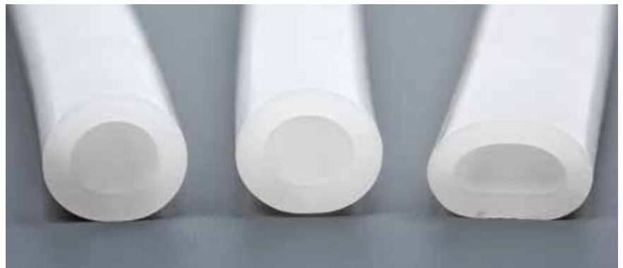
Schwankungen in der Extrudatgeometrie
