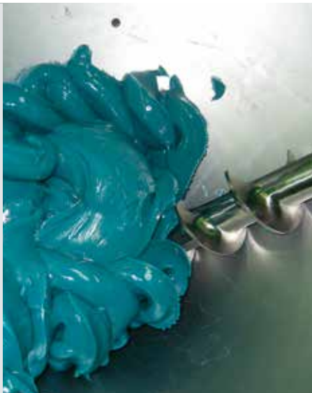
Innenansicht RotoFeeder®: Zuführtrichter mit Förderschnecke
