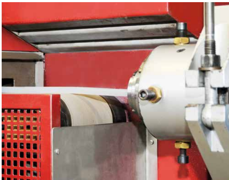
Extrusion von ELASTOSIL® Festsiliconkautschuk zu Schläuchen
